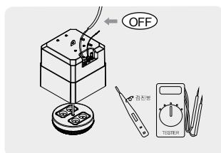
제품 설치, 청소, 유지보수 시 반드시 메인 전원을 끄고 전원 OFF를 확인하십시오.
