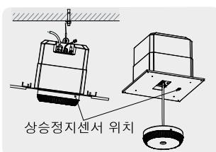
경사진 천장에 설치 시에는 상승정지 센서가 경사면의 낮은 방향에 위치하도록 하십시오.
